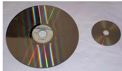
Εικόνα 73. Συγκριτική φωτογραφία Laserdisc και CDROM
