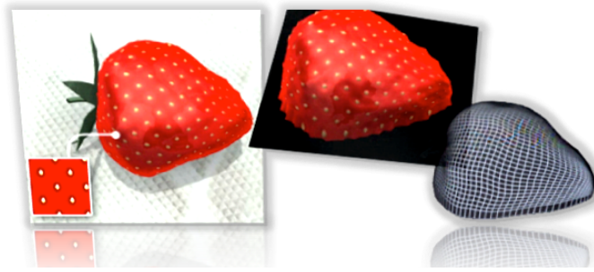
Εικόνα 51. Αναπαράσταση της διαδικασίας 3D ψηφιοποίησης με την τεχνική σχήμα από υφή
