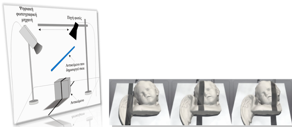
Εικόνα 50. Αναπαράσταση της διαδικασίας 3Δ ψηφιοποίησης με την τεχνική σχήμα από σκιά
