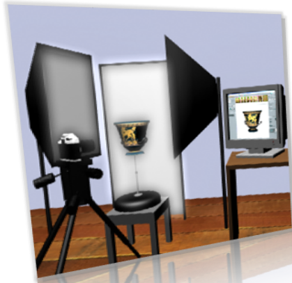
Εικόνα 42. Σχηματική αναπαράσταση της τεχνικής σχήμα-από-σιλουέτα
