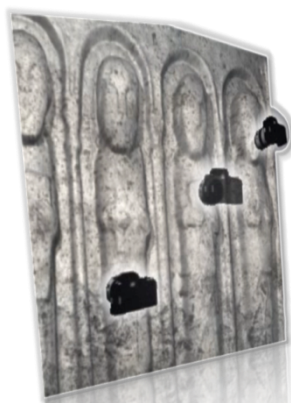
Εικόνα 46. Αναπαράσταση της διαδικασίας 3Δ ψηφιοποίησης με την τεχνική σχήμα από βίντεο
