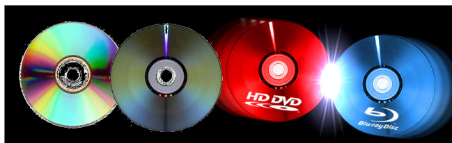
Εικόνα 74. Διάφοροι τύποι οπτικών δίσκων (από αριστερά, CD, DVD, HD-DVD, Blu-Ray Disc)
