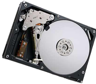
Εικόνα 72. Εσωτερική όψη ενός σύγχρονου σκληρού δίσκου
