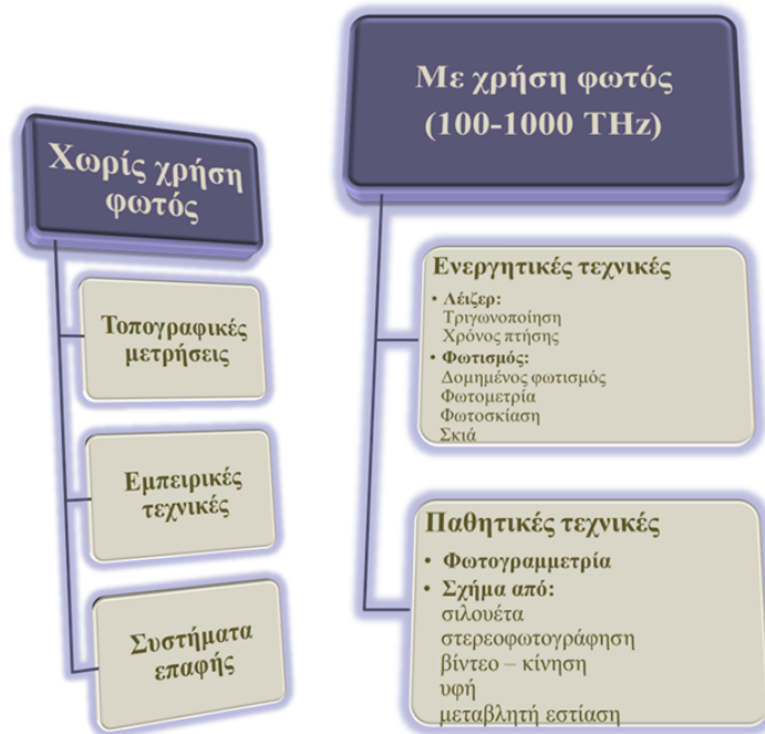
Εικόνα 32. Κατηγοριοποίηση τεχνολογιών 3D ψηφιοποίησης με βάση τη χρήση φωτός
