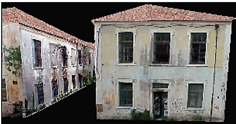
Εικόνα 31 Εικονικό μοντέλο φωτογραμμετρικής αποτύπωσης επίπεδων όψεων κτιρίου
