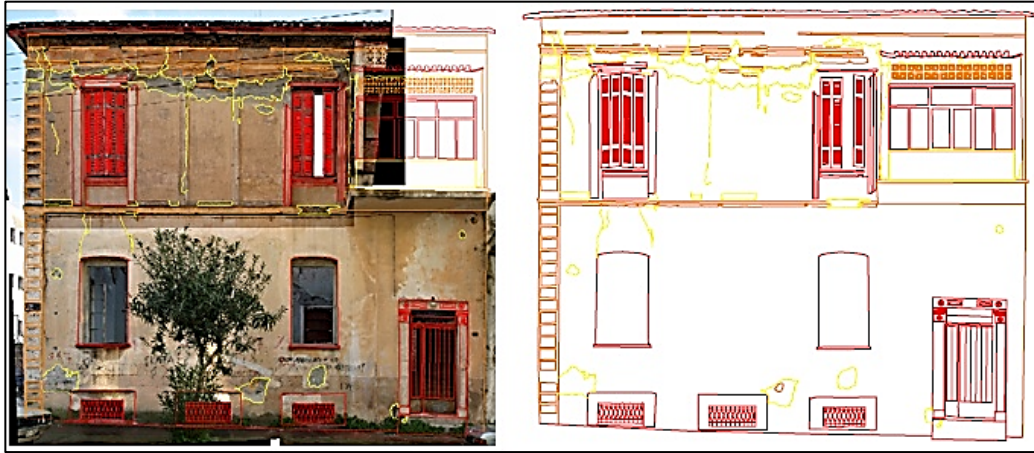
Εικόνα 30 Φωτογραμμετρική απόδοση και τελικό διάγραμμα όψης διατηρητέου κτιρίου
